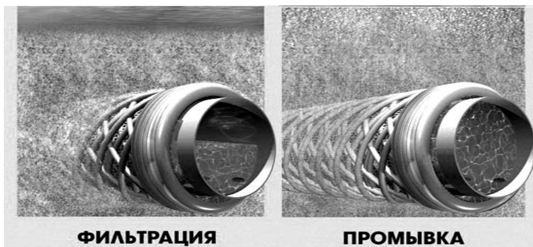
Рисунок 2 - Сбор отфильтрованной и распределение промывной воды дренажно-распределительной системы
