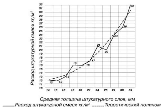
Рис. 3. Расход сухой штукатурной смеси кг/м<sup>2</sup> в зависимости от средней толщины штукатурного слоя, мм
