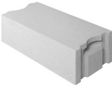
Основная плотность продукции, которая производится на заводах компании Аэрок, имеет плотность 300 или 400 кг/куб.м. При этом прочность блоков составляет В 2,0 или В2,5 в зависимости от плотности. Такой класс прочности позволяет смело использовать блоки для строительства несущих стен двух- или трехэтажных домов. При этом стены из газоблоков плотностью 300 на 67% теплее стен из газобетона плотностью 500. Таким образом, стена толщиной
