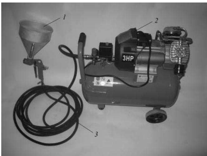
Рис. 2. Комплект технологічного обладнання, яке використовується для замонолічування стиків тонкостінних елементів огорожувальних конструкцій: 1 – бункер-пістолет; 2 – пересувний компресор; 3 – шланг повітряний
