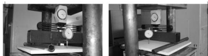
**Фото. 3. Приспособление для испытания стыков гипсокартонных образцов**
