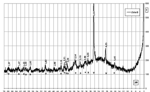
Рис. 2. Дифрактограма золи виносу: V — кварц, + — муліт, X — кальцит
