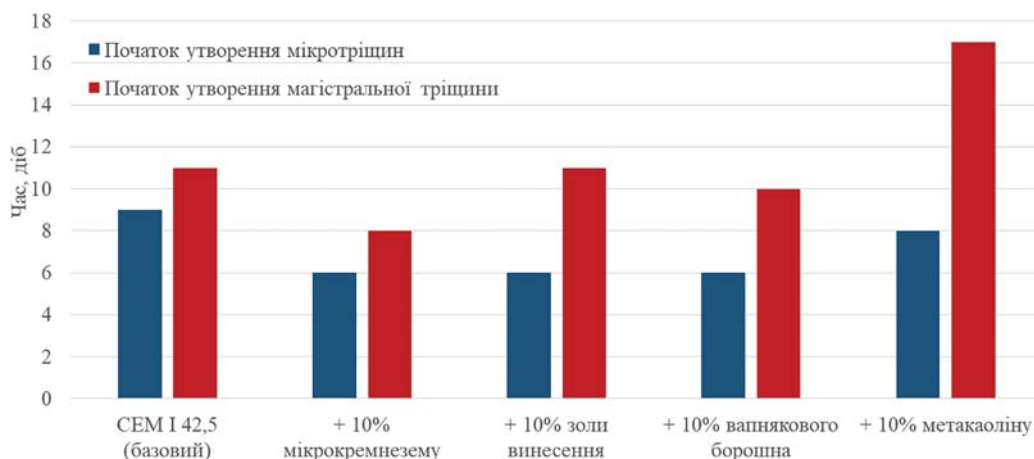
Рис. 5. Прогнозований час початку утворення усадочних тріщин в досліджуваних бетонах
