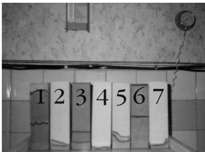
Рис. 1. Капиллярный подсос образцов ячеистого бетона плотностью 300, 400, 600 кг/м<sup>3</sup> (2, 4, 7), керамического (1, 3, 6) и силикатного (5) кирпича
