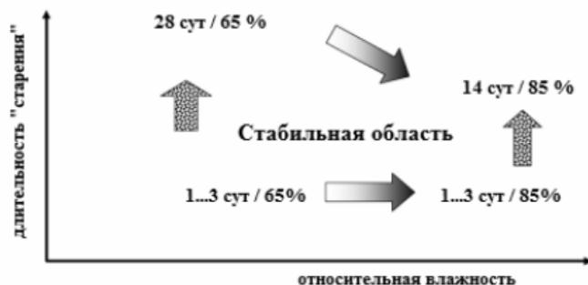
Рис. 3. Область стабильности при «старении» строительного гипса
